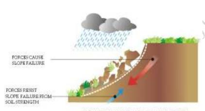
EROSION CAUSED DESTABLIZING FORCES
